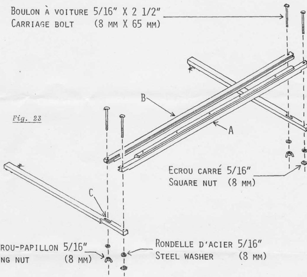
Fixer la semelle du battant A (avec glisseuse à navette) au bas des épées C. Insérer un boulon à voiture 5/16" X 2 $\frac{1}{2}$ " (8 mm X 65 mm) à chaque bout de la semelle A, puis dans le trou des épées C. (Fig. 23)
