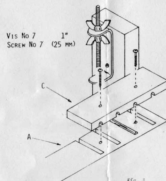
Fixer ensuite les blocs de retenue C à l'aide de vis à tête ronde No 7 de 1" (25 mm). (Fig. 3)
