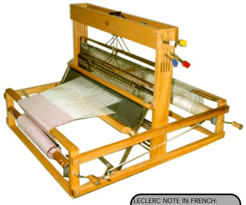
Pour un métier 8 lames mettre le cliquet de tête plus haut et identifier que la tête #1 va au millieu et la tête #2 à l'arrière.
