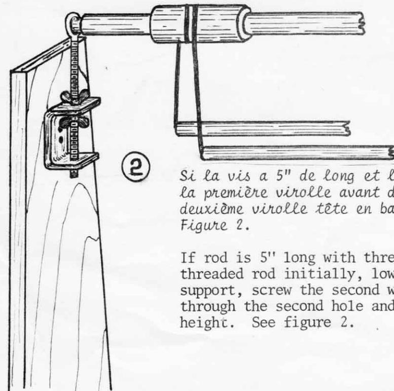
*Si la vis a 5" de long et les filets presque jusqu'à l'oeillet, posez la première virolle avant de l'introduire dans le support et la deuxième virolle tête en bas sous la partie supérieure du support. Figure 2.*
