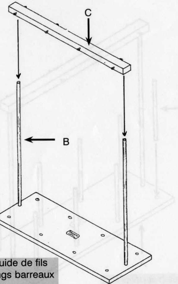
Installer le guide de fils C sur les longs barreaux B.
