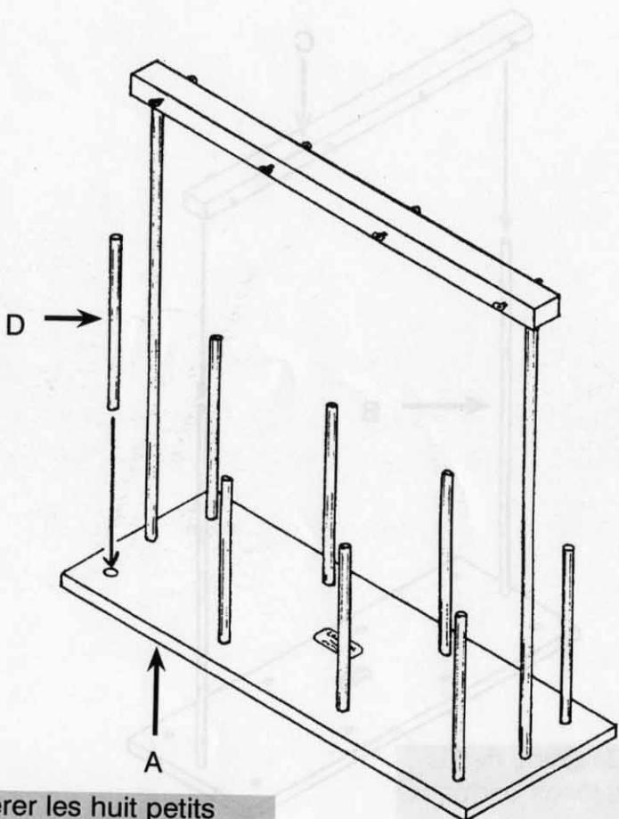
Insérer les huit petits barreaux D dans les trous de la base A.
