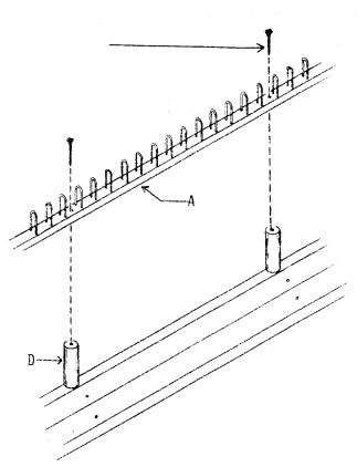
Fixer les râteaux (A) sur le dessus des douilles de bois (D) à l'aide des vis No 14 de 2" (50mm) fournis avec l'ensouple ourdissoir
