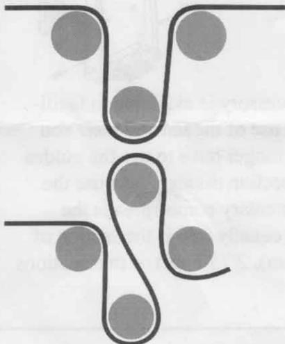
Montage standard avec 3 rouleaux pour une tension normale.
