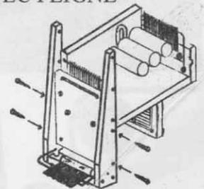
Cette accessoire est disponible pour faciliter l'usage de la boîte à tension. Vous n'avez plus besoin d'utiliser les guides sur les crampes puisqu'avec le peigne supplémentaire, les fils se placent sans problème dans la section de 1" (25 mm), 2" (50mm) ou 2 sections de 1" (25 mm)
