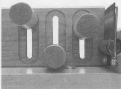
Mettre les rouleaux en place et les placer selon la tension voulue. Plusieurs configuration est possible.
