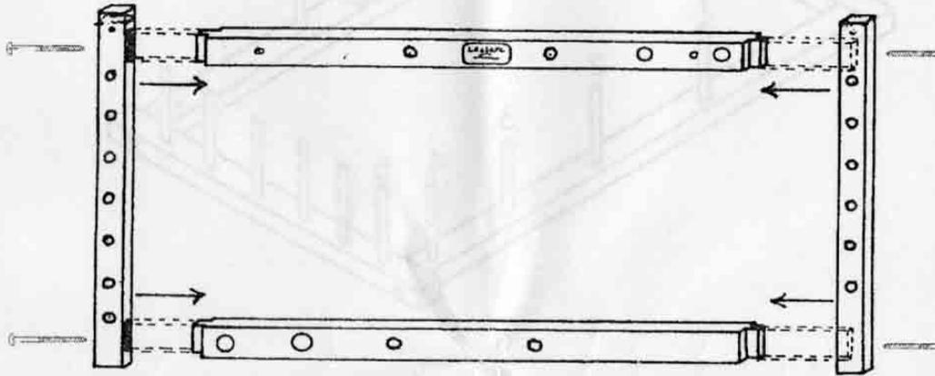
Joindre les côtés gauche et droit aux traverses supérieur et inférieur tel qu'illustré. Visser les 4 boulons 8-32, 1¼" pour stabiliser le cadre.
