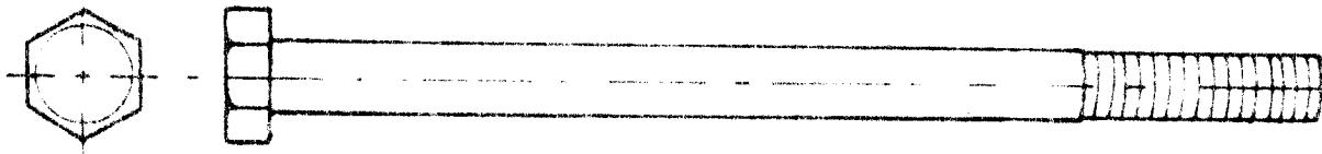
4 boulons à machine 3/8" X 5"
