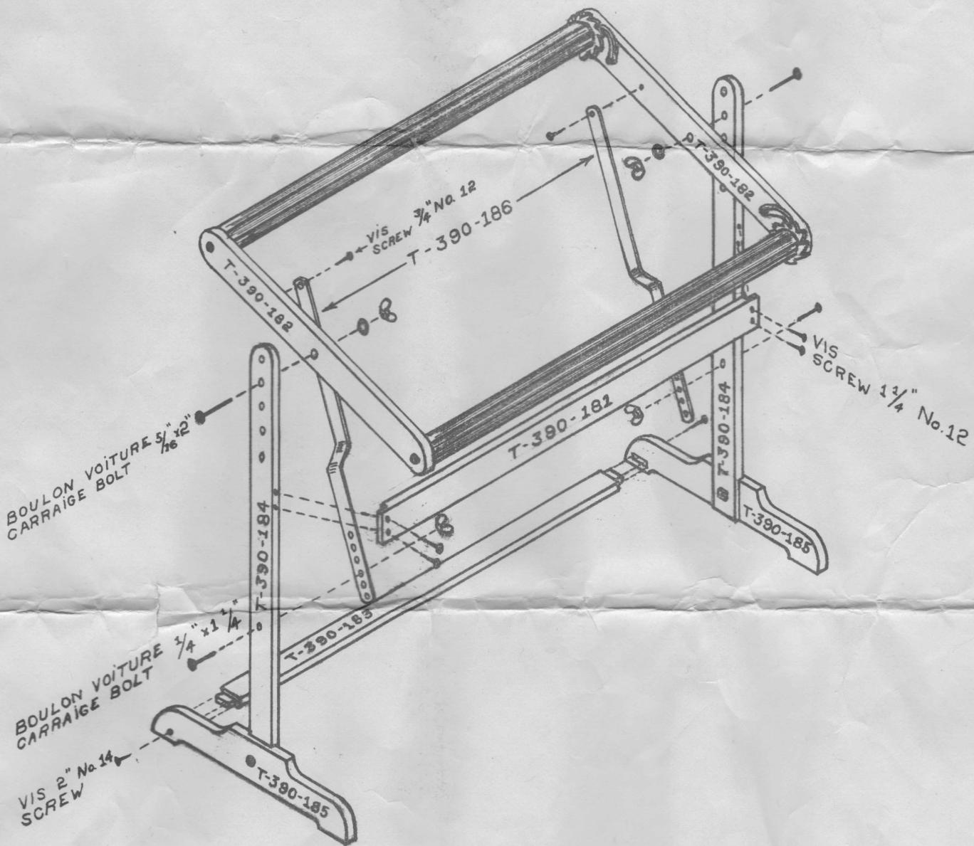
Fixez la traverse T-390-181 aux montants T-390-184 en utilisant les vis 1 $\frac{1}{4}$  x 12, ensuite fixez la traverse T-390-183 aux pattes T-390-185 en utilisant les vis 2 x 14.
