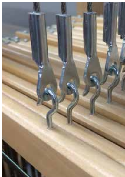
Assurez-vous que les bagues des câbles soient parallèles aux bois de cadres afin d'éviter qu'ils accrochent pas à ceux-ci.
